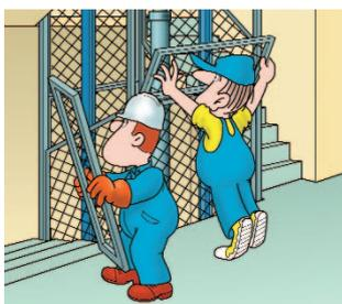
**Difese vano:** negli impianti inseriti in vano scala, le protezioni che delimitano il vano corsa devono avere un'altezza minima dal piano di calpestio, di 2.5 m (precedentemente era prevista una altezza di 1,70 m).
