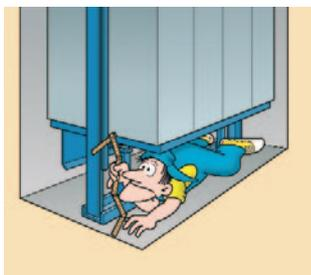
**Altezze libere in testata e fossa:** su tutti gli impianti deve essere assicurata agli estremi del vano corsa (fossa e testata), un'altezza libera minima di 0,50 m, quale spazio di sicurezza per il tecnico manutentore.
