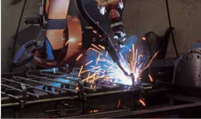
La saldatura automatica Automatic welding
