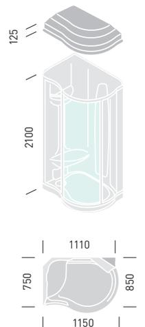
Misure in millimetri
