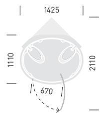
Evolution è stata progettata per essere installata su pareti in muratura. In caso di pareti diverse (legno, cartongesso) provvedere a rinforzarle adeguatamente per garantire un fissaggio sicuro.
