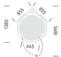
Evolution è stata progettata per essere installata su pareti in muratura. In caso di pareti diverse (legno, cartongesso) provvedere a rinforzarle adeguatamente per garantire un fissaggio sicuro.
