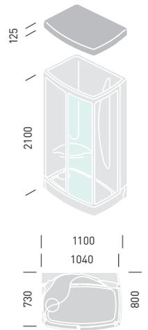
Misure in millimetri
