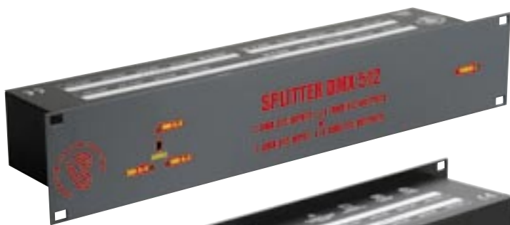
Versione RACK con connettori a 3 pin XLR SPLITTER DMX-512 RACK CODICE W170 Dimensioni 48x9x10,5 cm - 2 unità rack RACK version 3 pin XLR connectors SPLITTER DMX-512 RACK CODE W170 Dimensions 48x9x10,5 cm - 2 rack units
