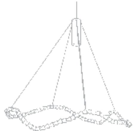
Hängeleuchte mit Hochvolt LED Streifen und Modularstruktur aus opalem Polycarbonat in Spritzgussform, fixiert an Plexiglasröhre mit fluoreszentem Spotlicht.
