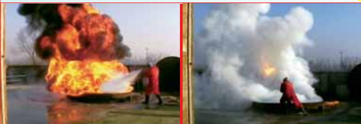
Prova di spegnimento classe 233B ( 155 lt di eptano ) con estintore a polvere da 6 kg
