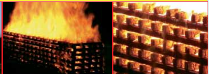
Fase di preaccensione di 8 minuti di una prova classe 34 A ( Catasta lunga 3,4 m )
