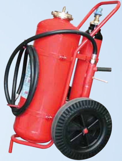
kg 100 polvere, bombola azoto 14 litri e riduttore. Getto e pressione costante fino alla fine scarica
