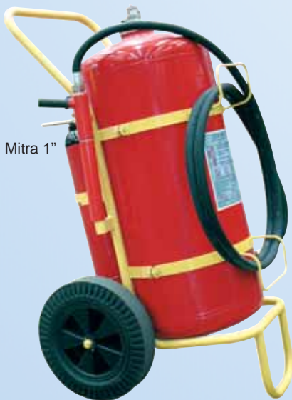
kg 100 polvere, bombola azoto diretta 7,5 litri. Pressurizzazione immediata in 5"
