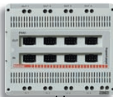
NODO AUDIO-VIDEO per miscelare il segnale proveniente da 4 sorgenti audio e/o video 2 fili
