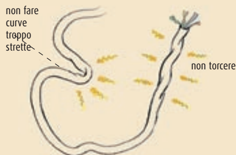
Esempio di cavo ritorto o danneggiato
