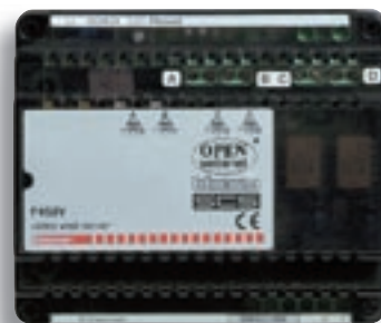
F452V WEB Server di controllo e supervisione video e di sistemi SCS MY HOME
