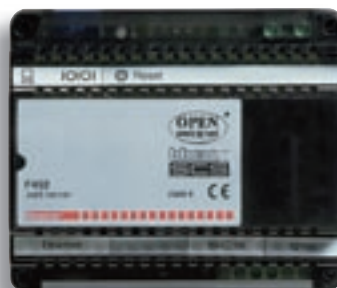
F452 WEB Server di controllo e supervisione di sistemi SCS MY HOME
