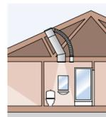
Tunnel solare rigido VELUX provvisto dell'adattatore per la ventilazione, installato in un bagno situato in un appartamento con sottotetto non abitabile. Il kit di ventilazione consente di collegare
