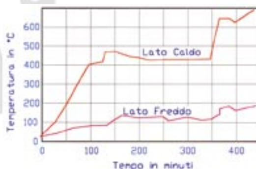
Temperature: Rivestito, valori rilevati sulla superficie in alluminio direttamente esposta al calore; Nudo, valori rilevati sulla superficie fredda del pannello.
