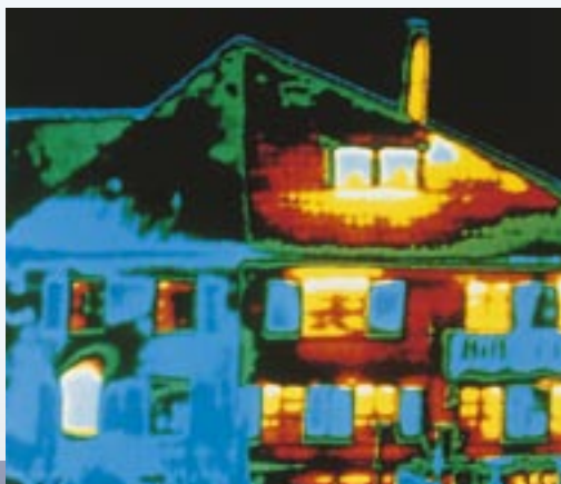
Fig. 1: Immagine termografica di un'abitazione. Le zone in arancione indicano un'elevata dispersione termica, dovuta ad un cattivo isolamento termico. Le zone in blu sono state isolate con prodotti fatti in Neopor®.
