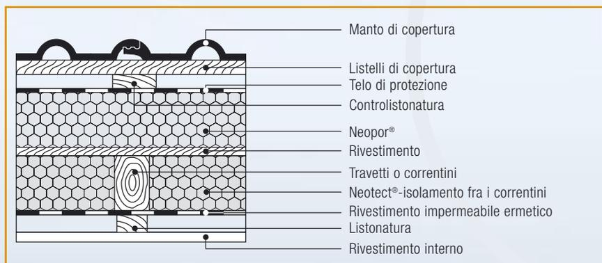
Fig. 7: Sistema di isolamento fra i travetti.
