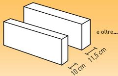
Suggeriamo l'uso di blocchi di 8 cm di spessore per la realizzazione di tramezzi di distribuzione o intercapedini, solo con altezze inferiori a 240 cm.
