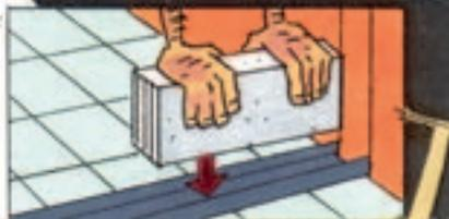
STENDENTE LA MALTA COLLANTE SULLA SUPERFICIE INFERIORE E SU QUELLA VERTICALE DEI BLOCCHI PRIMA DI INFILARLI NEL PROFILO A "U".
