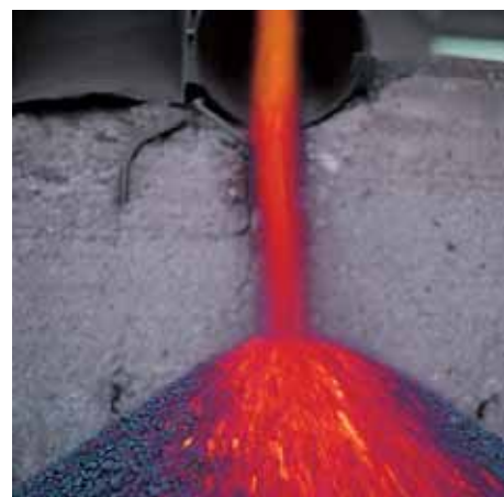
L'argilla espansa, prodotta a 1200 °C, è definita "Classe A1", cioè assolutamente incombustibile.
