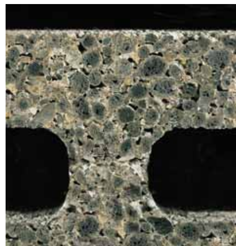
Il Termoblocco è confezionato con sabbia, argilla espansa e cemento.
