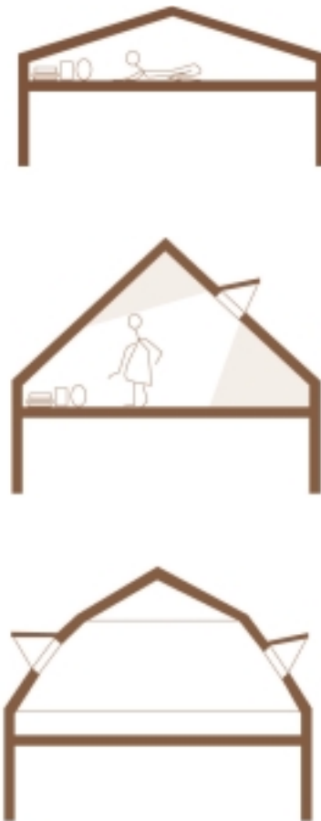
Intervenendo sulla pendenza o sulla conformazione delle falde, indipendentemente da altri fattori, è possibile migliorare la funzionalità del sottotetto.
